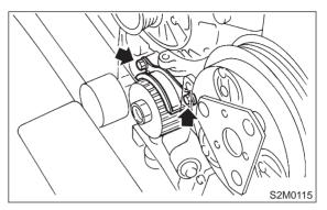
16) Remove crankshaft sprocket.
